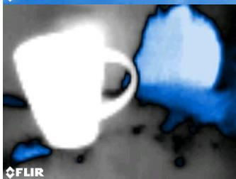
**Fig. 5-6 (b)** Auto-escala de paleta bloqueada lejos del objeto caliente
